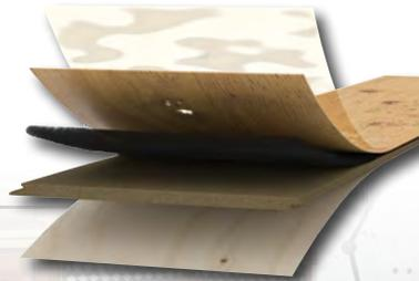
**Produktaufbau:** Deckschicht aus Eiche, Wood-Powder-Schicht, HDF-Mittellage und Echtholz-Wood-Powder-Gegezug
